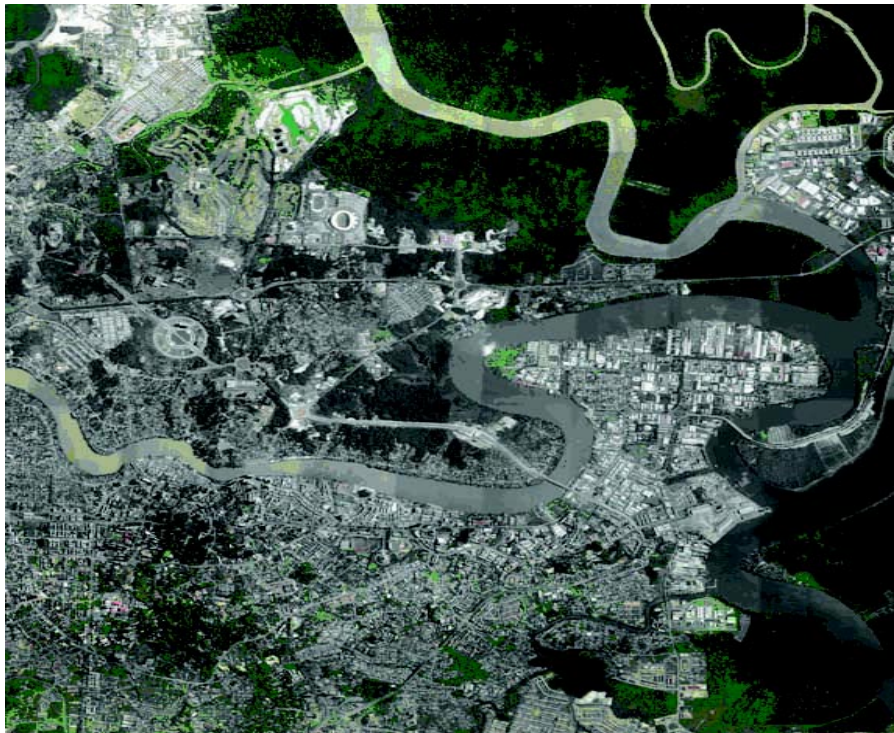
Rajah 7: Ortofoto Kuching dihasilkan menggunakan kamera udara RC30 sedia ada yang dilengkapi dengan Sistem Georujukan Terus (DGS)
