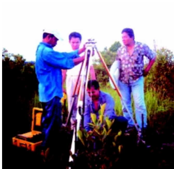
Kakitangan JUPEM sedang menyiapkan kerja-kerja pemasangan alat GPS sebelum bacaan data dilakukan
