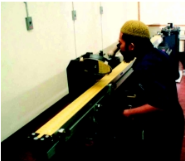
Kalibrasi dilakukan ke atas Staf Ukur Aras bagi memastikan kejituannya
