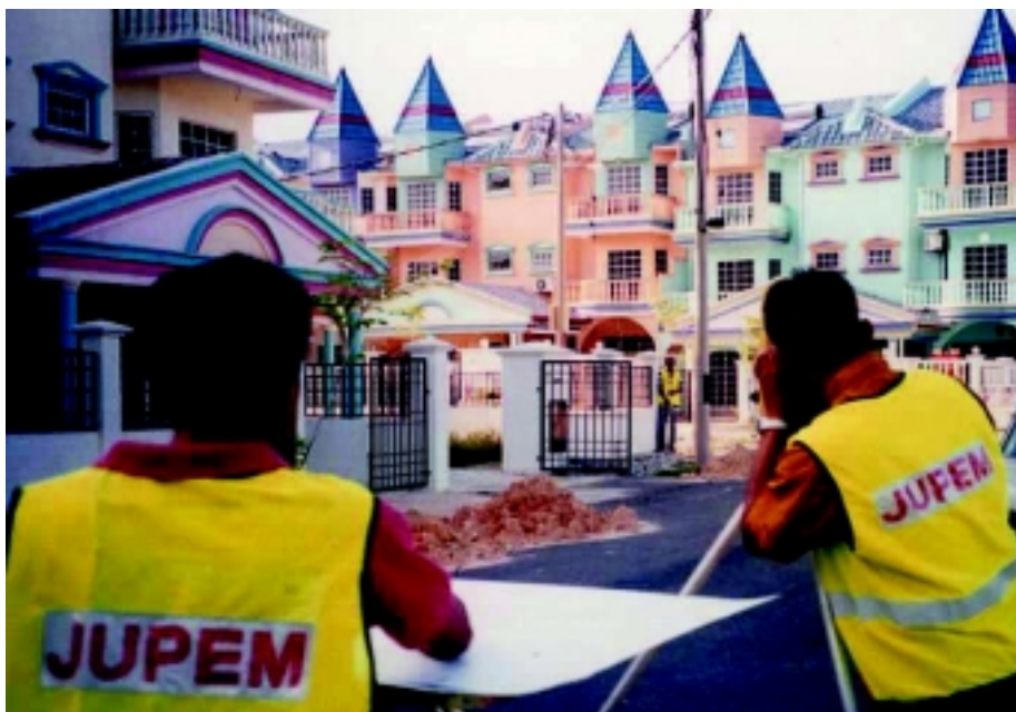
Kerja-kerja mengemaskini maklumat pemetaan dilakukan melalui Ukuran Mejaukur Penghabisan
